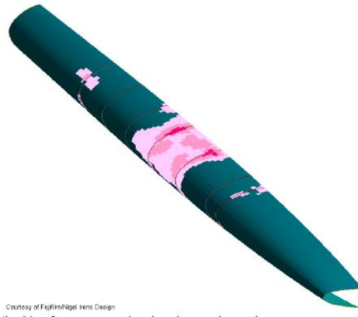
图4 舰艇项目的过载区域检查
